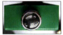
Bild 10: Die LEDs sind, in einer Optik montiert, in der Gehäusewand befestigt...
