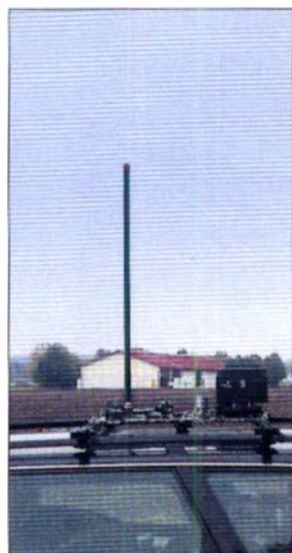
Bild 10: Von DK2RZ hergestellte, lediglich 0,9 m lange DXM-Antenne [5] für 40 m; Antennenkoppler ratsam
