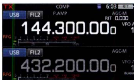
Bild 5: Displaybeispiel für den Dualwatch-Betrieb. Im oberen Band kann man auf 144,3000 MHz senden.
