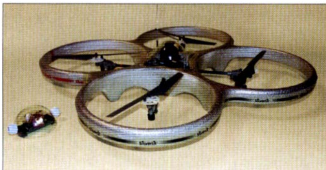
Bild 1: Die Baugruppe des Messsenders liegt hier nur auf der Oberseite des Quadcopters. Sie ist vor dem Start noch auf der Unterseite zu befestigen. Daneben befindet sich eine separat nutzbare Leiterplatte mit Schutzkappe.
