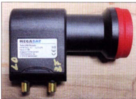
Bild 1: Umgebauter LNB mit eindeutigen Anschlussbezeichnungen
