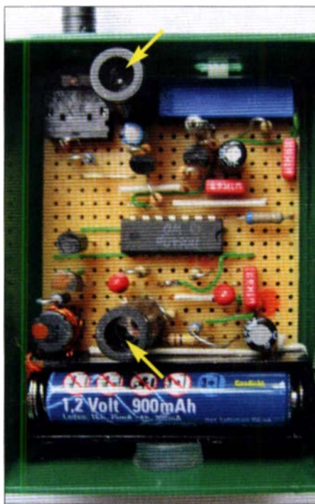
Bild 13: Zweikanalempfänger, die beiden Fototransistoren sind so angeordnet, dass ihre lichtempfindlichen Öffnungen zum durchsichtigen Gehäusedeckel gerichtet sind.
