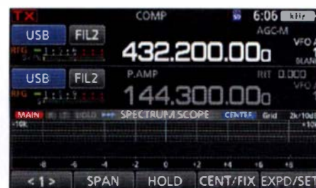
Bild 7: Beim Dualwatch-Betrieb ist nur Platz für ein Miniskop, das zur oben im Display angezeigten Frequenz gehört.
