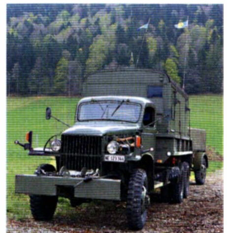
SM-46 mit Aggregat, zwei Rutenantennen am Heck (RX) und einer auf dem Dach (TX) Foto: HB9FWY
