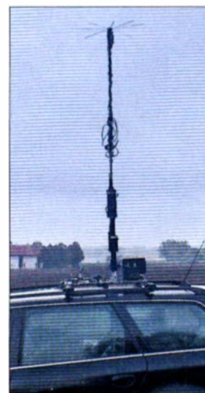
Bild 8: DJ0HV-Antenne für 80 m mit 1,2-m-Strahler, 0,5 m Dachkapazität und zwei Spulen, Abspannseil aufgewickelt
