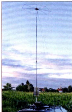
Bild 1: Eigenbauantenne (XXL) für 160 m mit 1 m Dachkapazität, 3,5-m-Strahler und 0,6 m Speiseleitung
