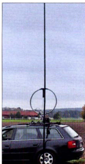
Bild 6: Resonante 10 m lange Vertikalantenne für 40 m, gegen Pkw-Chassis erregt; 90-cm-Loop nur fürs Foto
