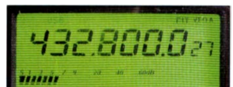
Bild 9: Bakensignal des QO-100 auf 10489,800 MHz an einem 80-cm-Offsetspiegel in JO31SK
