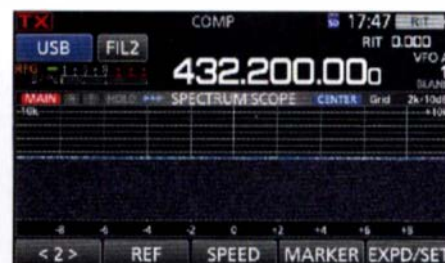
Bild 8: Eingeschaltetes Spektrumskop/Wasserfall im 70-cm-Band
