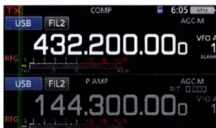
Bild 6: Längeres Drücken auf den Lautstärkesteller des Hauptbandes vertauscht die Bänder.
