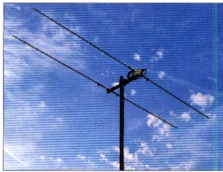
Bild 15: 2-Element-18-Ω-Direktor-Yagi für 70 MHz Foto: DK7ZB
