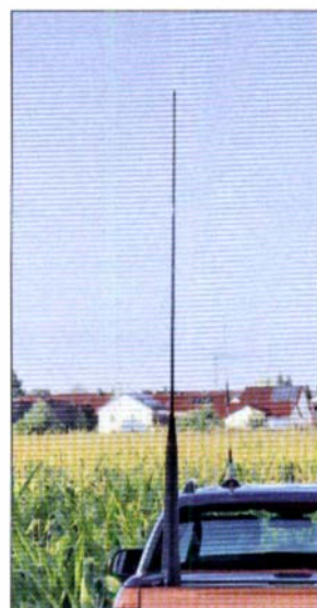
Bild 7: Stealth Telecom 9360 für 160 m bis 10 m mit kurzem Standardstrahler an einem Pick-up Ford Ranger 32
