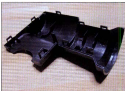
Bild 3: Demontiertes Unterteil des Außengehäuses mit den acht Einrastfenstern
