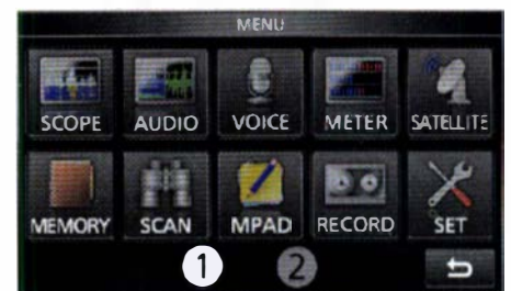
Bild 11: Der Menu -Bildschirm 1 wurde im Vergleich zum IC-7300 mit dem Satellite -Menü ergänzt.
