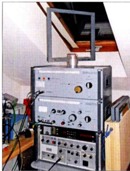
Bild 4: Labormessplatz, eingerichtet bei DL7SAQ im etwa 10 m hohen Holzdachgeschoss; H-Feldmessplatz, H-Peilrahmen, selektiver Differenzverstärker mit VLF-Empfänger als Stromversorgung darunter und HF-Messempfänger Fotos: HB9CVQ
