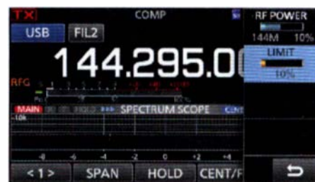
Bild 14: Wenn die Leistungsbegrenzung aktiviert ist, bleibt die versehentliche manuelle Erhöhung der Sendeleistung ohne Wirkung.
