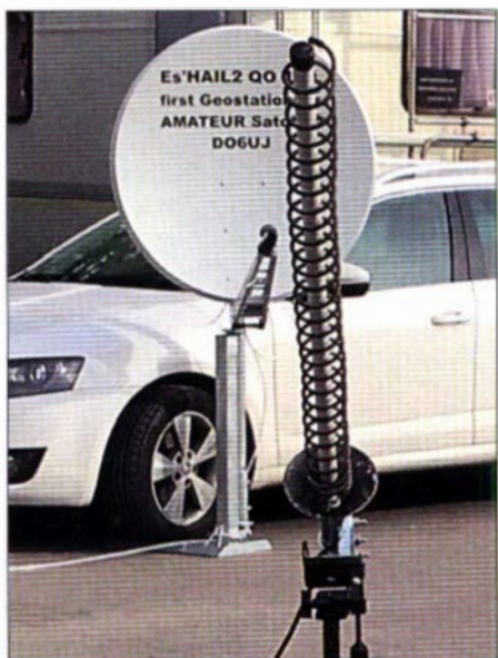
Für den Empfang des QO-100 im 3-cm-Band ist eine handelsübliche Offset-Parabolantenne mit einem umgebauten LNB nutzbar. Zum Senden ist eine rechtsdrehende, zirkular polarisierte Antenne für das 13-cm-Band erforderlich. Foto: DM2CMB
